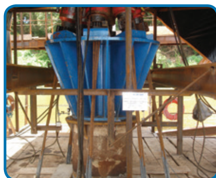
Prova de carga estática com tirantes de reação para 720 tf - Juruí - PA
