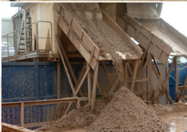
Centrais desarenadoras de lama bentonítica para hidrofresa
