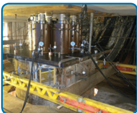
Prova de carga estática em solo com tirantes de reação para 3600 tf Manaus - AM
