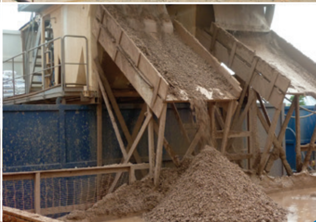
Centrales desarenadoras de lodo bentonítico para hidrofresa
