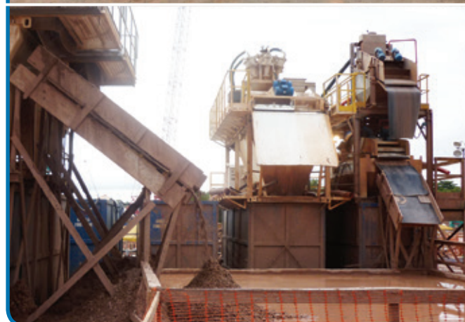
Centrales desarenadoras de lodo bentonítico para hidrofresa
