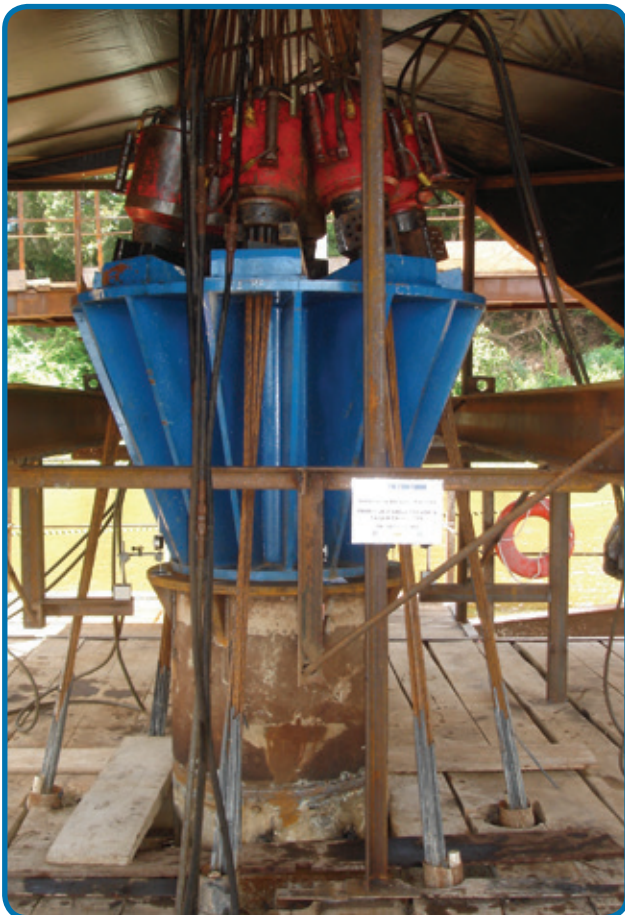
Prueba de carga estática con tirantes de reacción para 720tf - Juruti - PA
