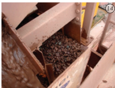
Figs. 13 e 14 - Material rochoso separado do fluido pela primeira fase do processo de limpeza.
