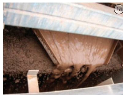
Figs. 15, 16, 17 e 18 - Ciclone desarenador primário e material médio de descarte, conjunto de ciclones secundários e material de descarte fino.
