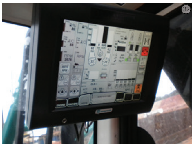
Figs. 32 e 33 - Displays da cabine de comando do guindaste com o controle e registro eletrônico das perfurações e eficiência do sistema em trabalho "real time"
