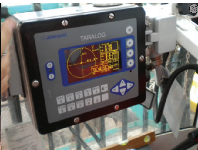
Figs. 32 e 33 - Displays da cabine de comando do guindaste com o controle e registro eletrônico das perfurações e eficiência do sistema em trabalho "real time"
