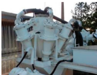
Figs. 15, 16, 17 e 18 - Ciclone desarenador primário e material médio de descarte, conjunto de ciclones secundários e material de descarte fino.
