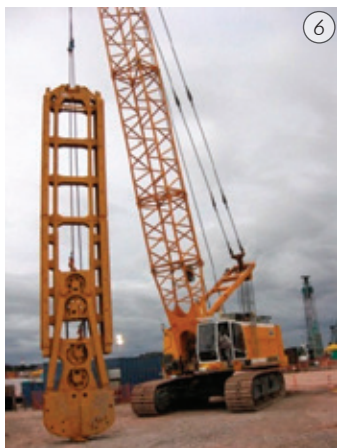
Imágenes 6 y 7 - Conjuntos de clam shell mecánicos e hidráulicos de alta precisión, Imágenes 8 y 9 - Conjuntos de hidrofresas Casagrande FD60 acopladas a grúas de alta potencia.
