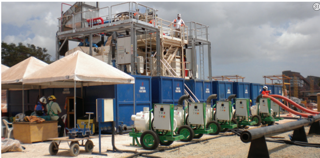
Imagen 31 - Vista de la Central de tratamiento de fluidos completa para dar soporte de forma simultánea a dos frentes de servicio en São Luiz - MA.
