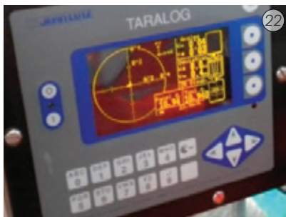
Imágenes 20,21,22 y 23. Pantalla táctil multifuncional, cabina de operación, pantalla de control multifuncional y registro de perforación "en tiempo real".
