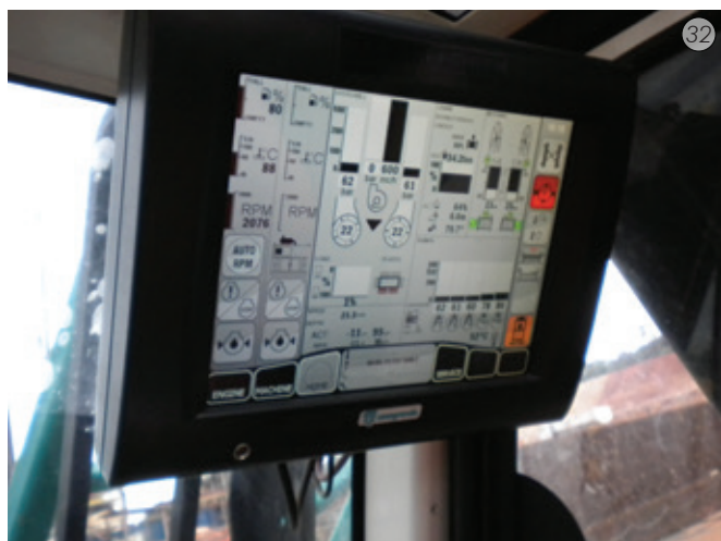
Imágenes 32 e 33 - Pantallas de la cabina de control de la grúa mediante control y registro electrónico de las perforaciones, y eficiencia del sistema en "real time".
