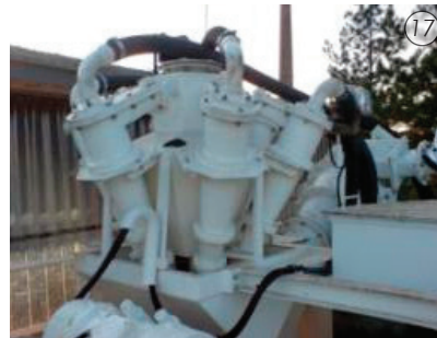
Imágenes 15, 16, 17 y 18 - Ciclón desarenador primario y material mediano de descarte, conjunto de ciclones secundarios y material de descarte fino.
