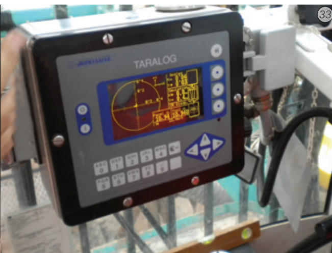
Imágenes 32 e 33 - Pantallas de la cabina de control de la grúa mediante control y registro electrónico de las perforaciones, y eficiencia del sistema en "real time".
