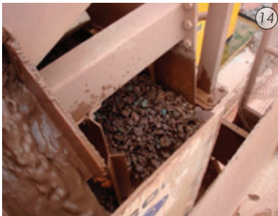
Imágenes 13 y 14 - Material rocoso separado del fluido por la primera etapa del proceso de limpieza.
