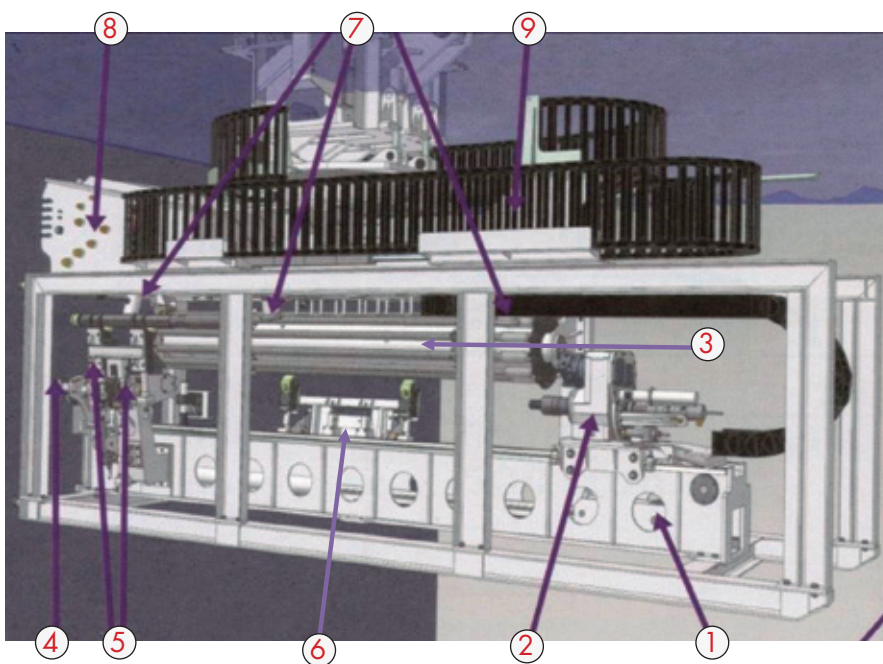
Fig. 21 - Detalhe esquemático da perfuratriz submersa.
