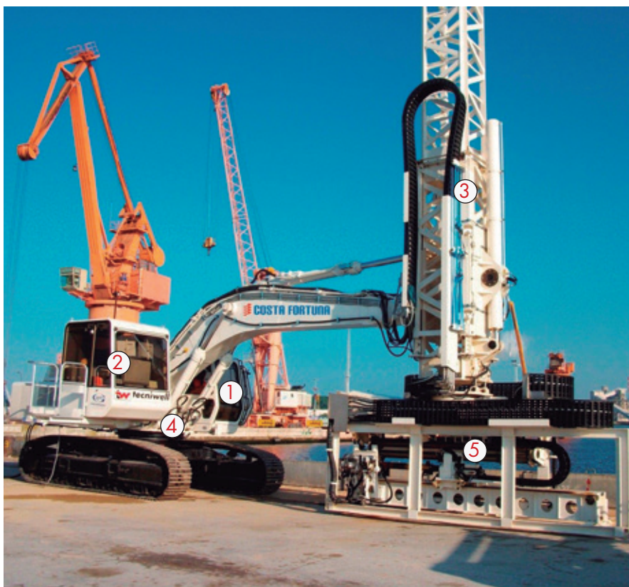
Fig. 20 - Equipamento para tirantes submersos pronto para operação.
