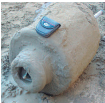
Fig. 10 - Bulbo de solo cimento exumado de um teste.
