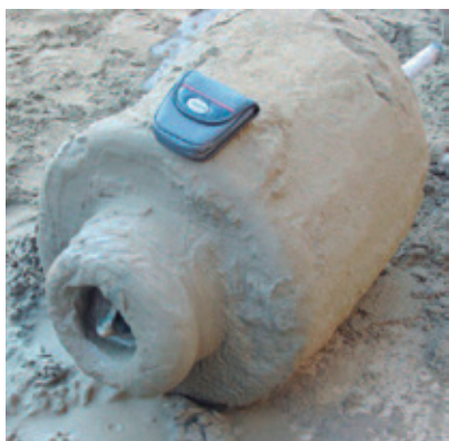
Imagen 10 - Bulbo de suelo cemento exhumado de un test.
