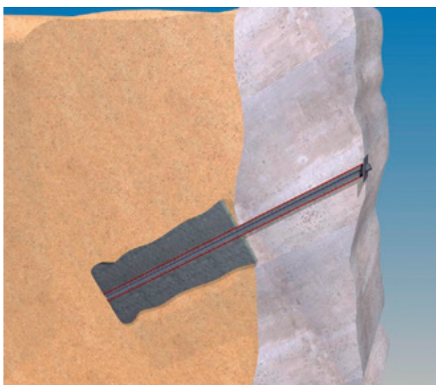
Imagen 5 y 6 - Refuerzos para cualquier estructura de contención, incluso sumergidas.
