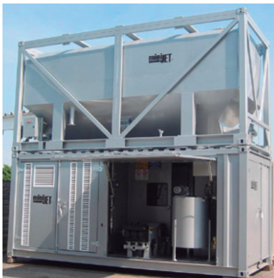
Imagen 22 Unidad compacta compuesta por silo horizontal, bomba y mezclador.
